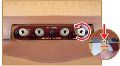
スピーカー端子のネジを左に回し、端子の穴が見えるまでゆるめてください。
