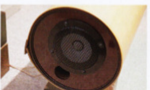
MS1001-Mのスピーカーユニット。スピーカーユニットの下には、バスレフのポートのような穴が開いている(左右ともに)。
