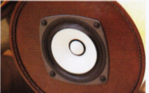
波動スピーカーに使われているスピーカーユニット自体は、特別高価なものではないという。ただ、背中あわせで正確配置するというレイアウトには理由があるという。
